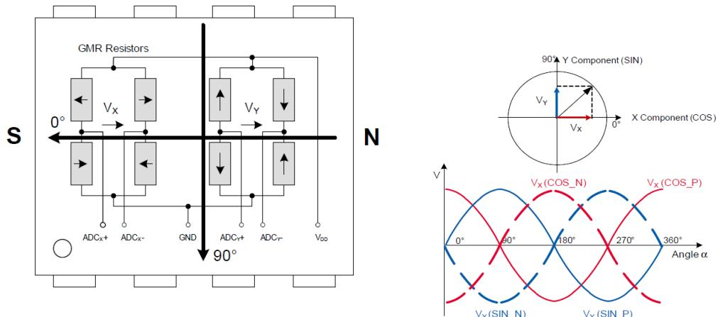
通过 Rotation Digital Computer (CORDIC)算法 , 可以得到一圈内任意位置角度。
